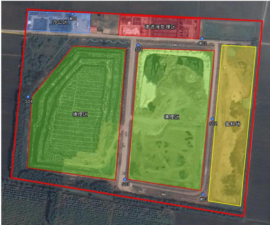
图 6-1 土壤监测点和地下水监测井分布图
