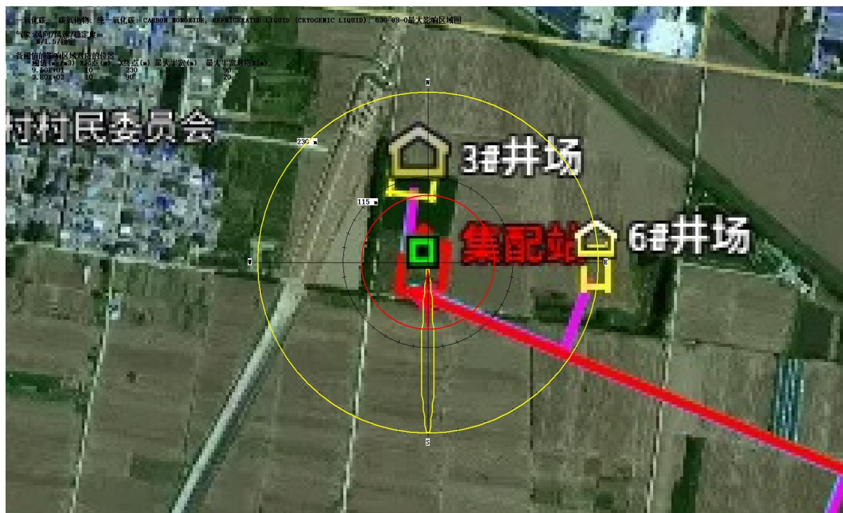
图 8.7.1-3 甲醇储罐泄漏次生 CO 影响范围图
