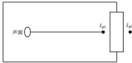
图 4-1 室内声源等效为室外声源图例
