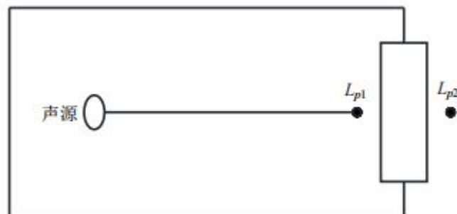
图 4-1 室内声源等效为室外声源图例
