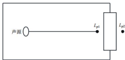
图 4-1 室内声源等效为室外声源图例
