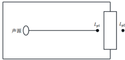
图 4-1 室内声源等效为室外声源图例
