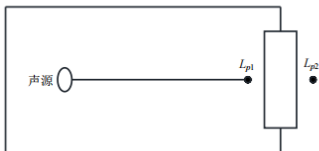
图 4-2 室内声源等效为室外声源图例
